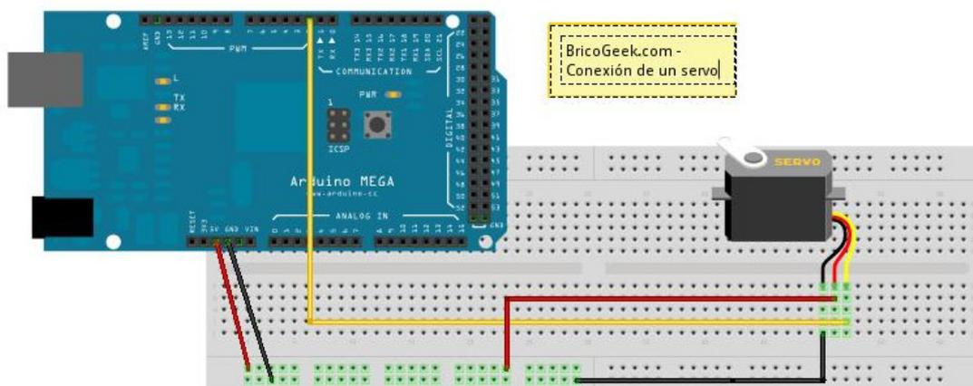
Tal como se observa en el gráfico, se conecta el servo al positivo que nos da arduino, y al GND también proporcionado por nuestro arduino, y por ultimo conectamos la señal de control (amarillo) al pin numero 2, marcado como PWM.
